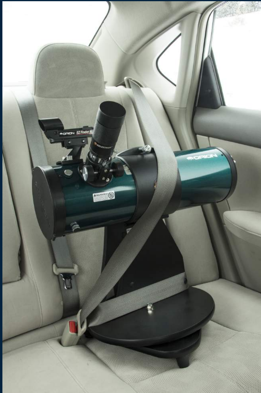
Figure 2 - Transport en voiture: instrument déposé sur le siège; ceinture abdominale serrée autour de la base; sangle de poitrine par-dessus le tube
